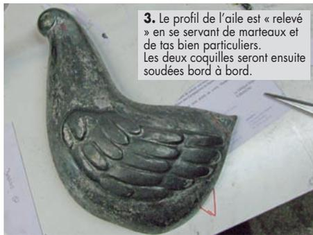
**3.** Le profil de l'aile est « relevé » en se servant de marteaux et de tas bien particuliers. Les deux coquilles seront ensuite soudées bord à bord.
